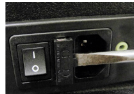
Abbildung 3: Lösen Sie die Hülse mit einem Flachschaubenzieher heraus
