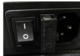
Abbildung 4: Tauschen Sie die Sicherung aus und drücken Sie die Hülse zurück an Ihren Platz
